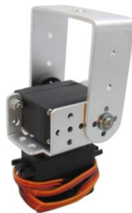
Figura 3-10: Pan&tilt escogido para el Proyecto
