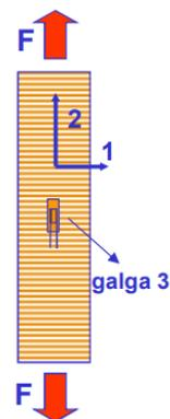
Figura 4.8. Esquema general utilizado para el cálculo de las propiedades de las probetas.
