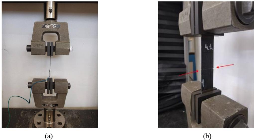
Figura 4.7. a) Esquema general del ensayo a 90°, y b) Rotura originada por fallo en la matriz de probeta UTP30.
