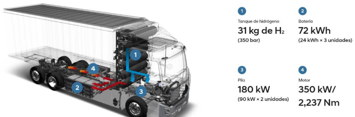
Figura 13: Tecnología de un camión propulsado por pila de combustible de hidrógeno. Fuente:( Hyundai)
