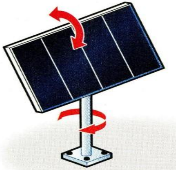
Figura 1-1 Ejes de giro: Elevación (arriba) y Azimut (abajo)
