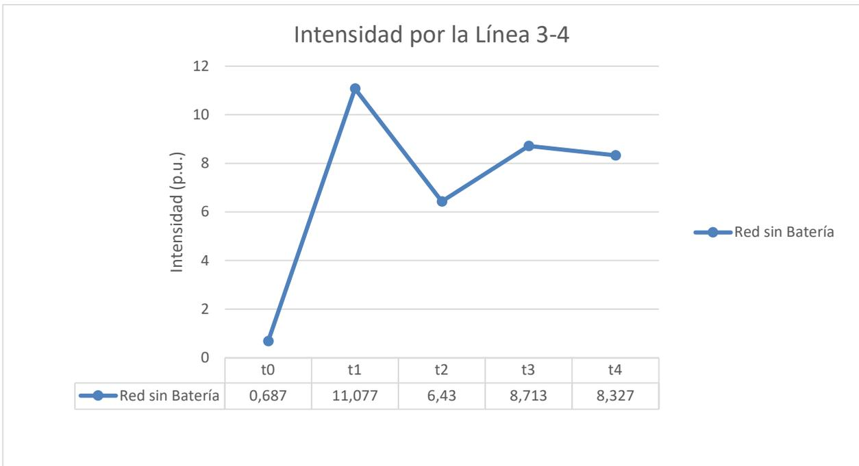
Figura 3-7 Resultado de la intensidad por la línea 3-4 en la red de 4 nudos sin batería
