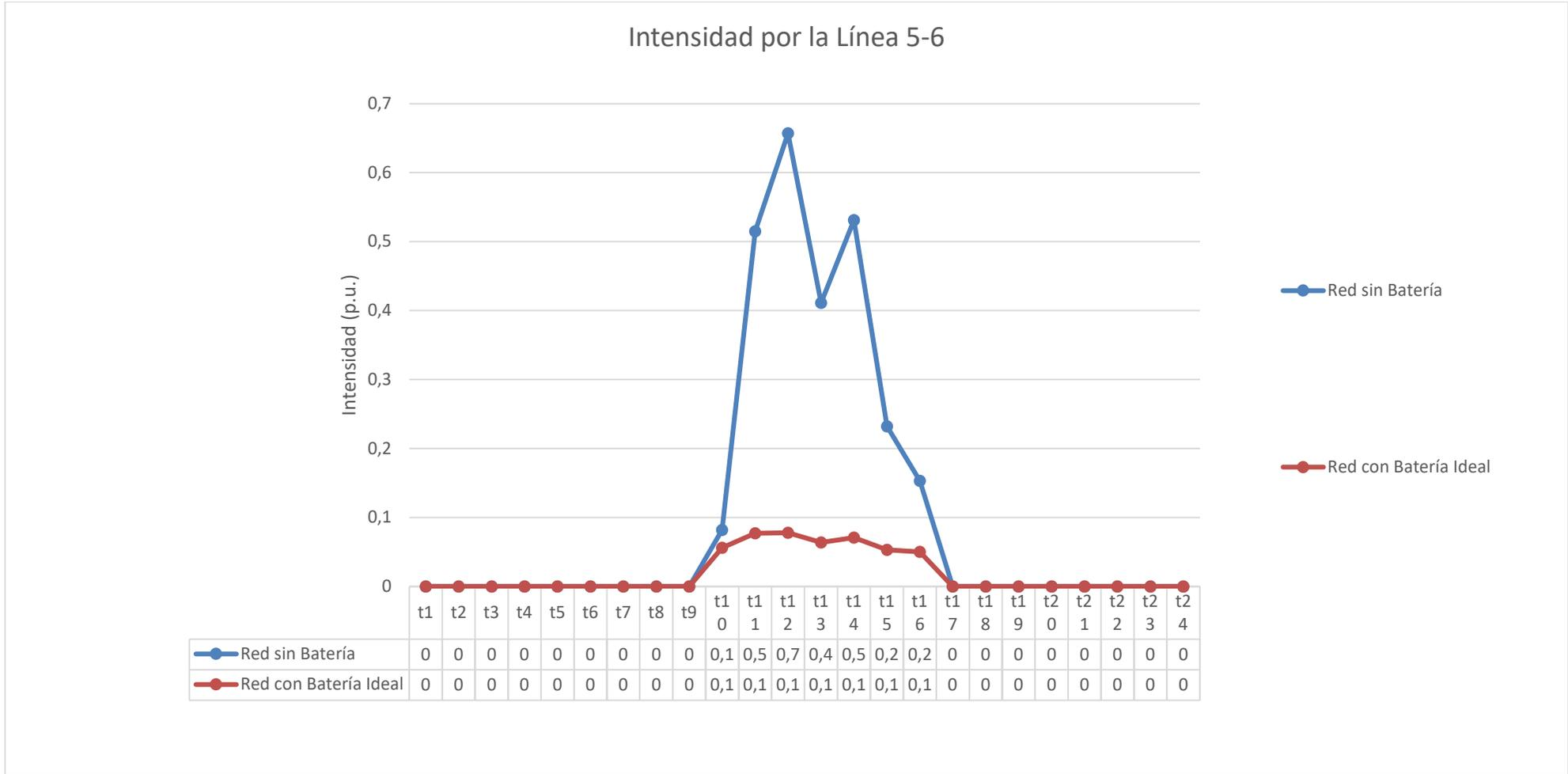
Figura 4-18 Resultado de la intensidad por la línea 5-6 en la red de escala de baja tensión sin batería y con batería
