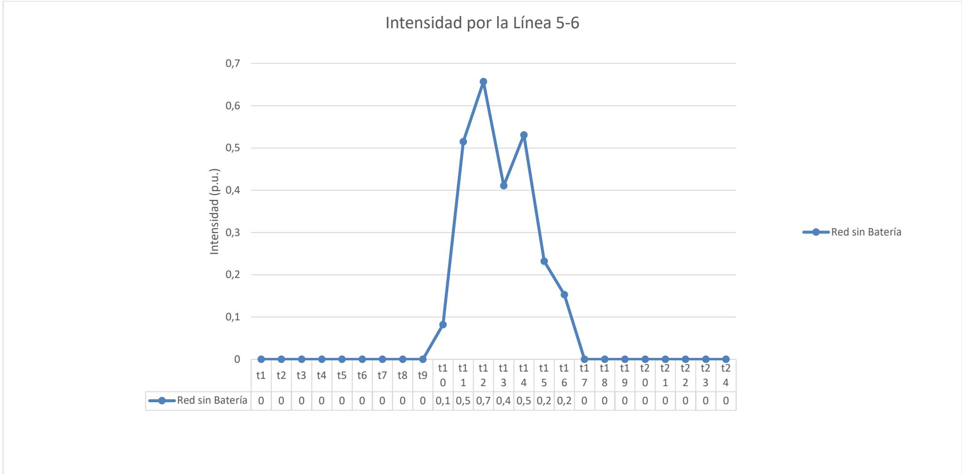
Figura 4-9 Resultado de la intensidad por la línea 5-6 en la red de escala de baja tensión sin batería
