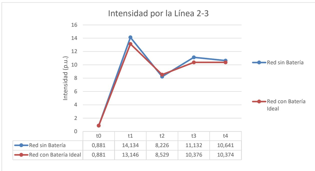
Figura 3-16 Resultado de la intensidad por la línea 2-3 en la red de 4 nudos sin batería y con batería
