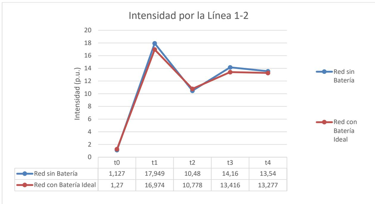
Figura 3-15 Resultado de la intensidad por la línea 1-2 en la red de 4 nudos sin batería y con batería
