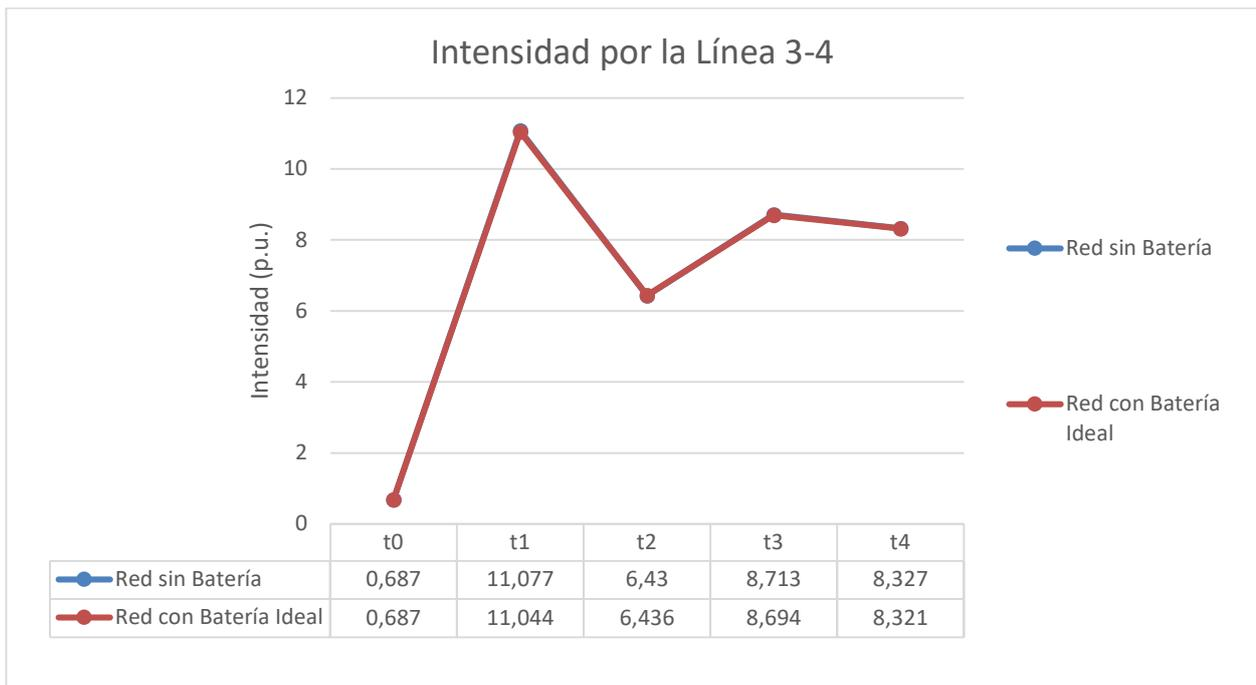
Figura 3-17 Resultado de la intensidad por la línea 3-4 en la red de 4 nudos sin batería y con batería
