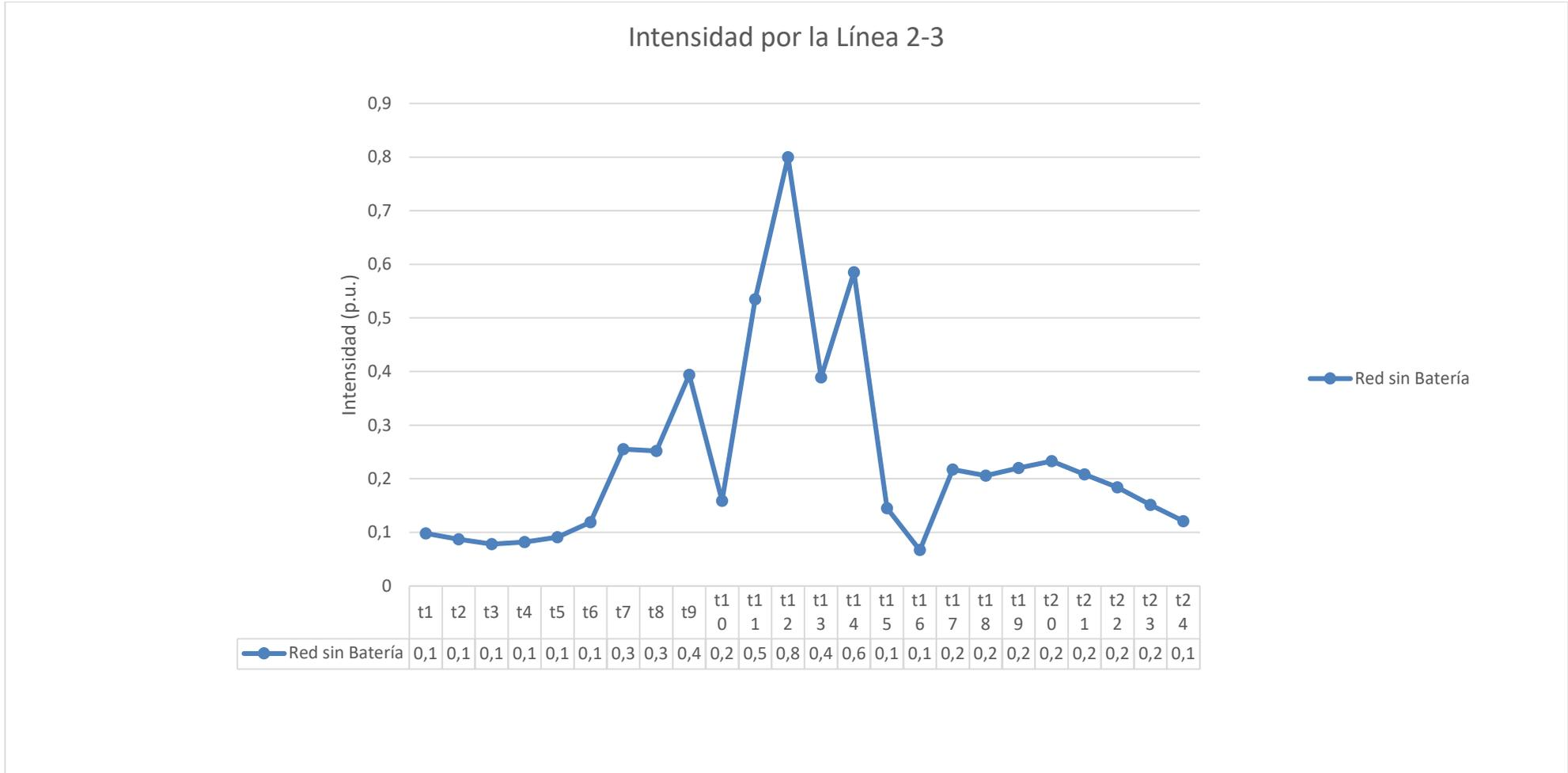
Figura 4-7 Resultado de la intensidad por la línea 2-3 en la red de escala de baja tensión sin batería
