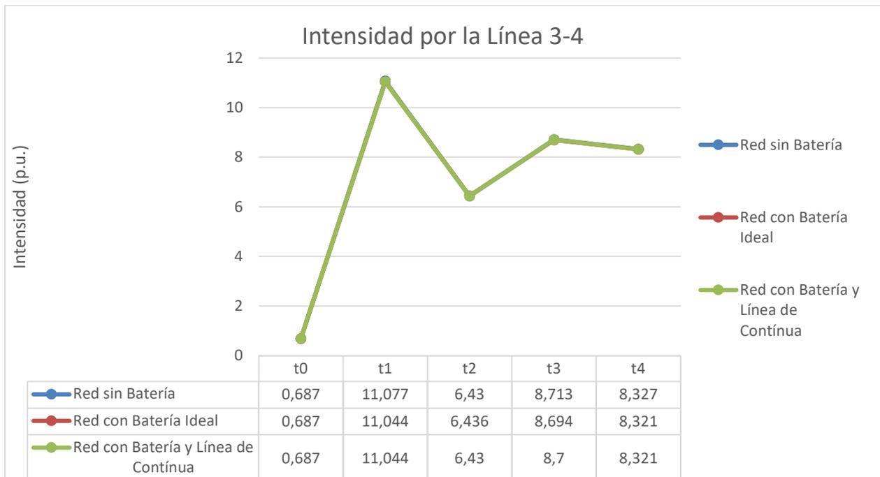
Figura 3-30 Resultado la intensidad por la línea 3-4 en la red de 4 nudos sin batería, con batería y con línea de continua
