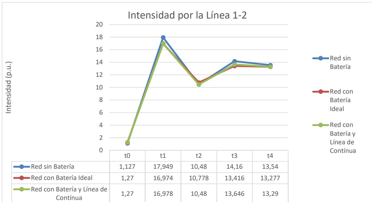
Figura 3-28 Resultado la intensidad por la línea 1-2 en la red de 4 nudos sin batería, con batería y con línea de continua
