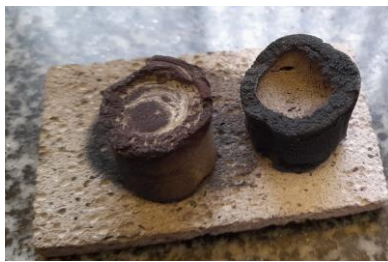
Figura 50. Burbuja en el interior de una pieza.
