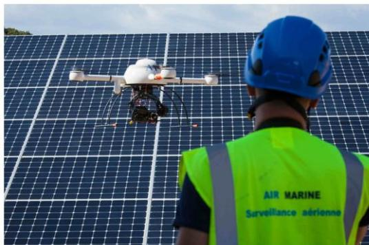
Ilustración 28. Microdron MD4-1000 utilizado para realizar la inspección [28].
