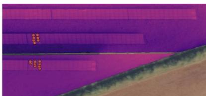
Ilustración 73. Imagen termográfica (Potencial de Degradación Inducida) de la Planta #6.
