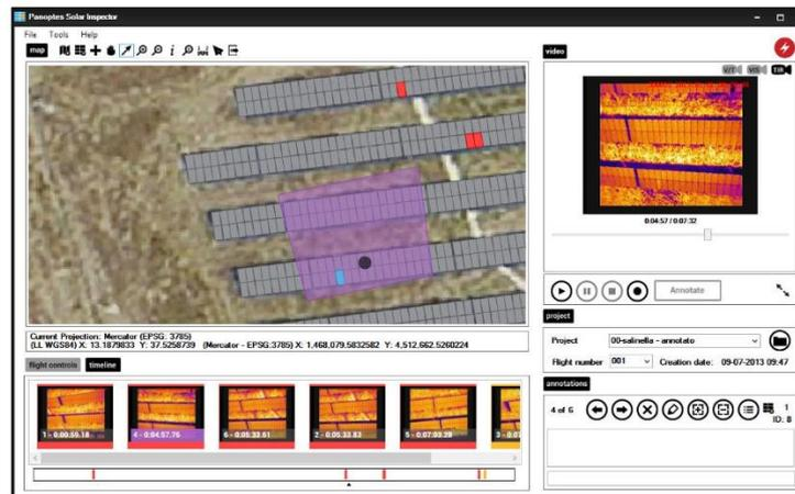
Ilustración 30. Imagen termográfica lista para el análisis [28].
