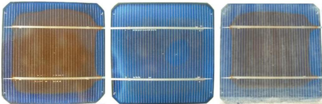
Ilustración 20. Varios grados de defectos de degradación de células de 18 años [25].
