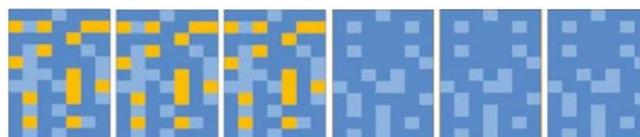
Ilustración 32. Ejemplo teórico string desconectado debido a diodos defectuosos.
