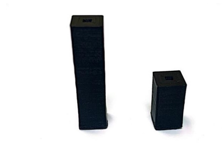
Figura 3.12 Conductos de luz impresos en 3D.
