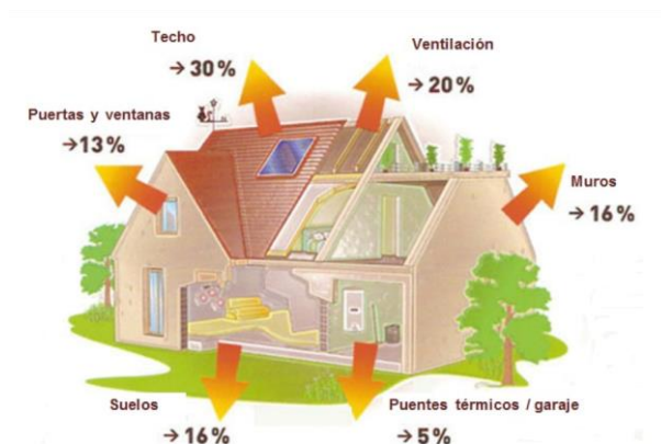
Ilustración 11. Pérdidas de calor en las viviendas.
