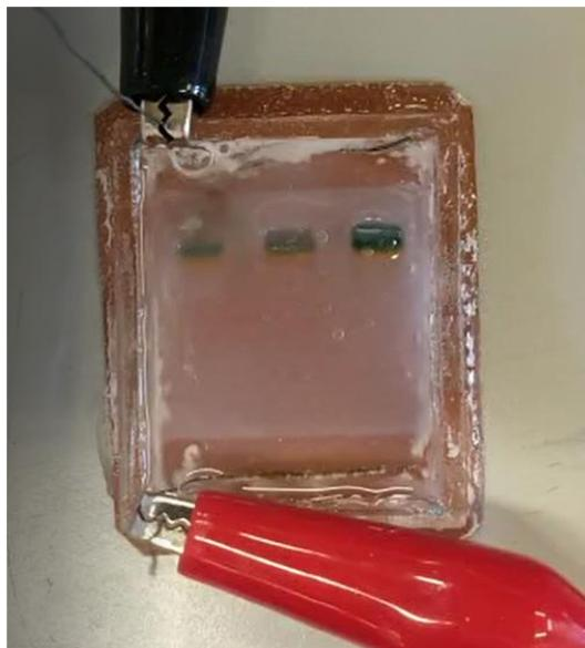
*Imagen del ADN después de 4 minutos de electroforesis:*
