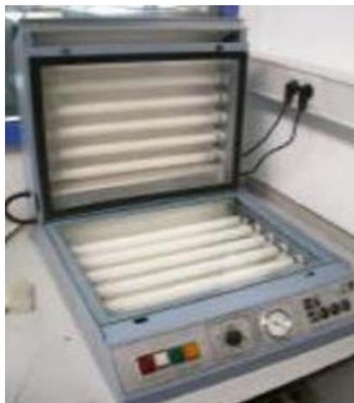
Aquí podemos apreciar la aisladora UV que tenemos en el laboratorio, con la que se ha trabajado para fabricar todas las placas electrónicas del dispositivo que estamos llevando a cabo.
