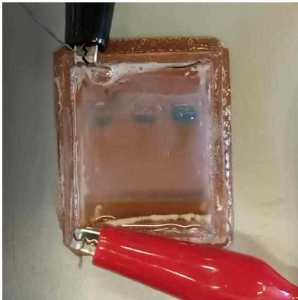
*Imagen del ADN después de 12 minutos de electroforesis:*
