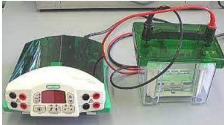
Ilustración 11: Sistema típico para realizar la electroforesis.
