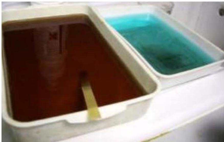
En la imagen previa, podemos observar como es el líquido revelador de PCB (izquierda) y el líquido atacante (derecha).
