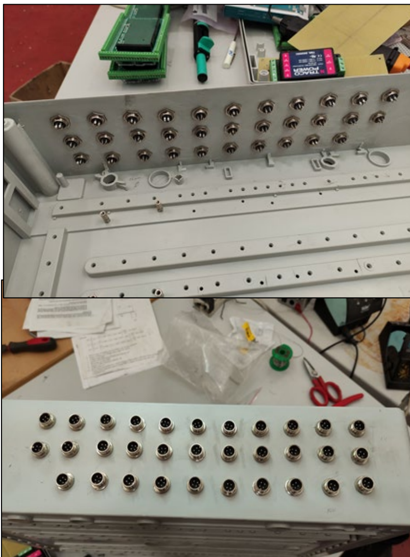
Figura 29. (a) Interior de la caja ABS con conectores GX-12 (b) Detalle exterior de las conexiones de la caja
