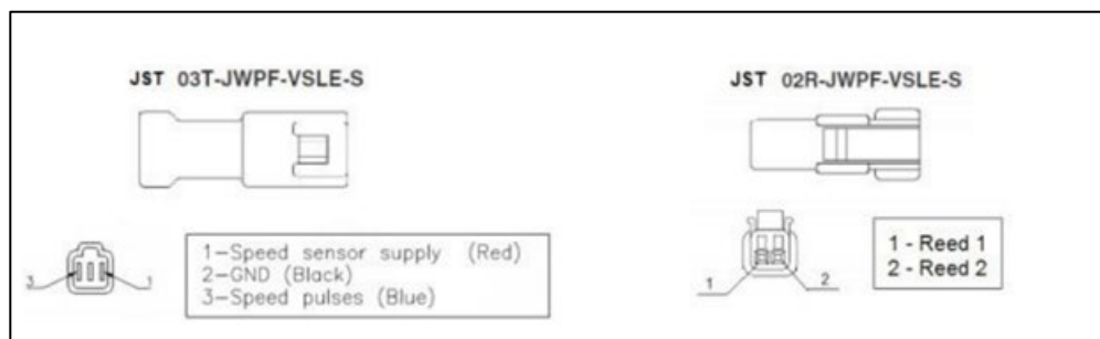
Figura 25. Sensor de efecto Hall (Derecha) y sensor de efecto inductivo o pasivo (Izquierda)
