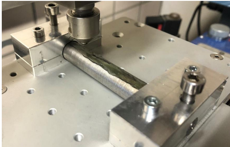
Figura 3.10 Probeta lubricada en el tribómetro antes de ensayar.
