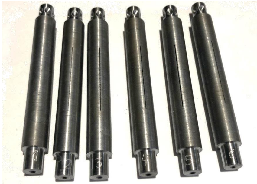
Figura 4.3 Huella en las probetas tras el ensayo de desgaste.
