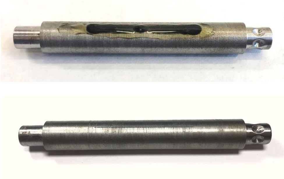
Figura 4.2 Probeta lubricada y probeta seca tras el ensayo de desgaste con tribómetro.
