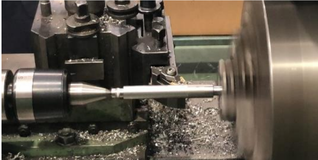
Figura 3.4 Montaje de la pieza en el torno.
