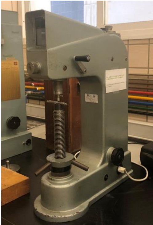
Figura 3.2 Medición de dureza en la probeta.
