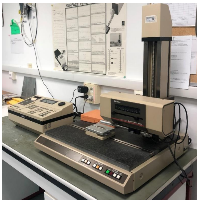
Figura 3.5 Rugosímetro Mitutoyo del Centro Andaluz de Metrología.
