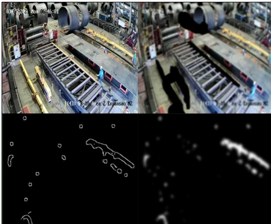
Figura 5–13. En sentido horario: (a) Imagen del stream de video. (b) Aplicación de una máscara y filtrado Gaussiano. (c) Filtrado por color en espacio HSV. (d) Detección de bordes mediante algoritmo de Canny.
