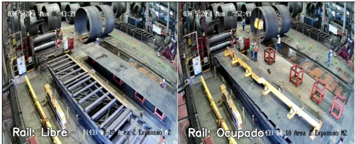
Figura 5–18. Si algo obstruye la visibilidad de los rodillos se considera que el rail está siendo utilizado.
