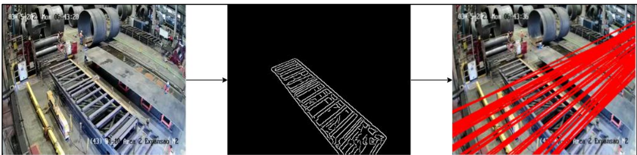
Figura 4–11. Detección de railes horizontales mediante Tfa. de Hough con OpenCV.
