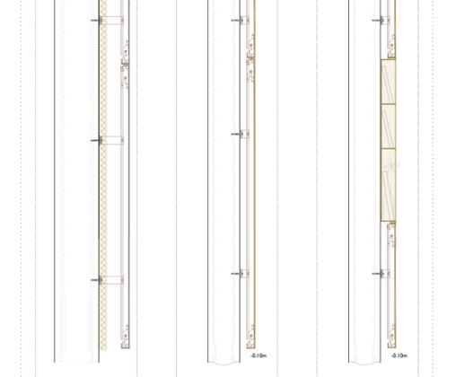
01 Muro de hormigón armado ME e=35cm HA-30-B/30, ambiente XA3 (ambiente de una alta) con nivel de control estadístico, con acero tipo B 500 S y resistencia al fuego de R 90. Encofrado mediante sistema ENKOFORM ULTRA textura tabillas de madera
