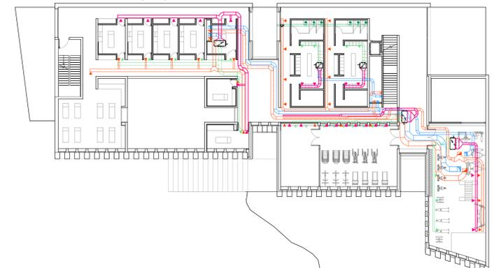
Instalación de climatización - ventilación. Planta menos uno, nivel seco... escala 1/300
