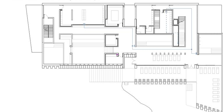
Instalación de telecomunicaciones. Planta menos dos, nivel húmedo... escala 1/300
