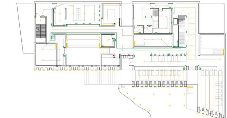
Instalación de electrotecnia. Planta menos dos, nivel húmedo... escala 1/300
