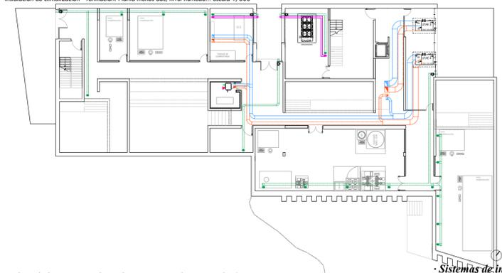
Instalación de climatización - ventilación. Planta menos tres, nivel técnico... escala 1/300
