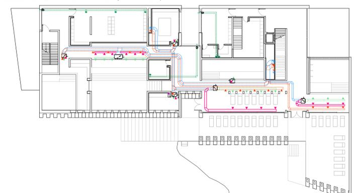
Instalación de climatización - ventilación. Planta menos dos, nivel húmedo... escala 1/300
