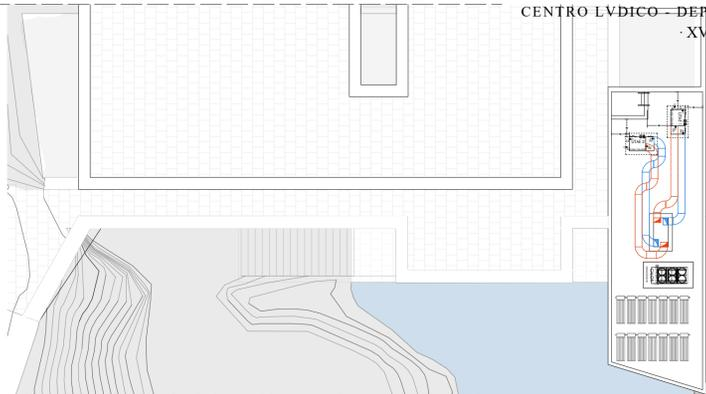
Instalación de climatización - ventilación. Planta de cubiertas, nivel plaza-mirador y cubierta de mantenimiento... escala 1/300
