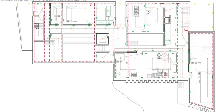
Instalación de electrotecnia. Planta menos tres, nivel técnico... escala 1/300
