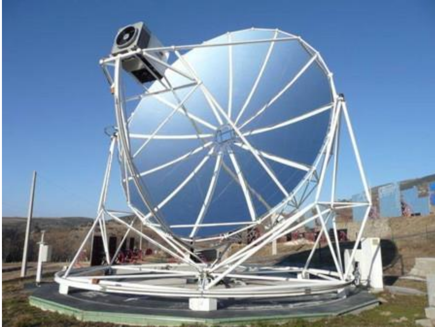
Figura 2.14 – Concentrador Solar de Disco
