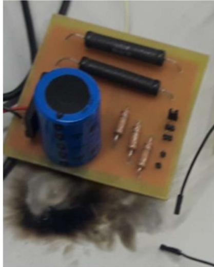
Figura 4-20. Fuente de alimentación dañada.
