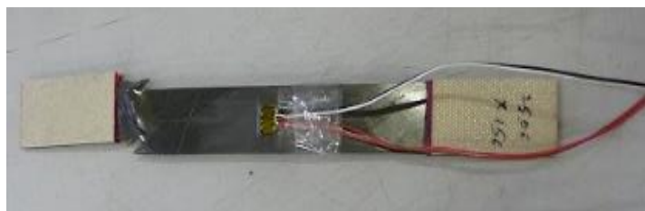
Figura 3-12: Posicionamiento de galgas en el ensayo equiangular \pm 45^\circ .
