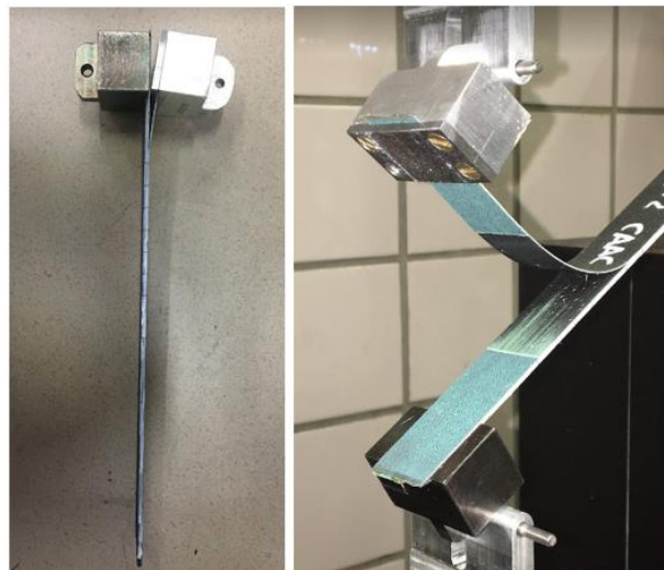
Figura 4-5: Colocación de los bloques de cogida sobre una probeta para ensayo DCB no simétrico.
