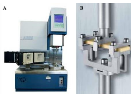
Figura 2.23. A: Analizador dinámico-mecánico RSA3. B: Geometría dual cantilever.
