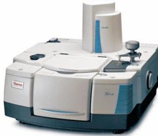
Figura 2.11. Espectrómetro FTIR Nicolet iS50.
