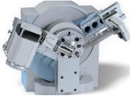
Figura 2.15. Difractómetro de polvo D81 90.
