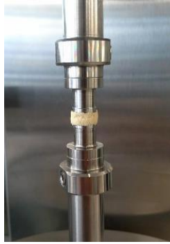
Figura 2.29. Geometría de platos paralelos de 8 mm de diámetro.
