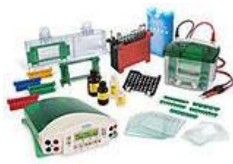
Figura 2.9. Equipo MiniProtein IV utilizado durante la electroforesis.
