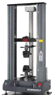
Figura 2.24. Máquina universal de ensayo MTS Insight 10 kN.
