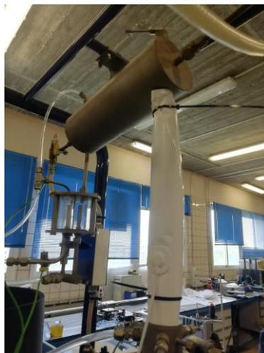
Ilustración 11: Colocación de manta térmica
