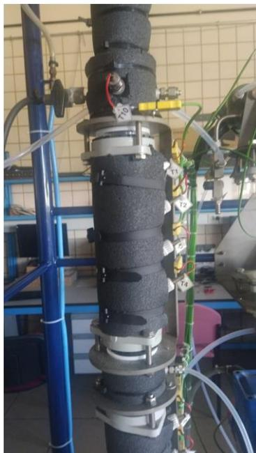
Ilustración 9: Aislante completo en la torre de platos
