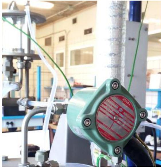
Ilustración 7: Válvula de Solenoide
