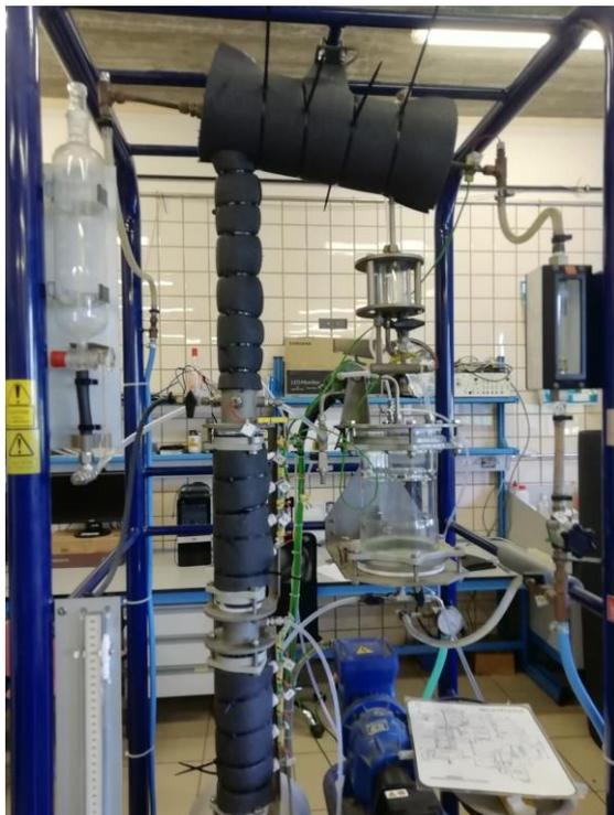
Ilustración 8: Planta con nuevo aislante
