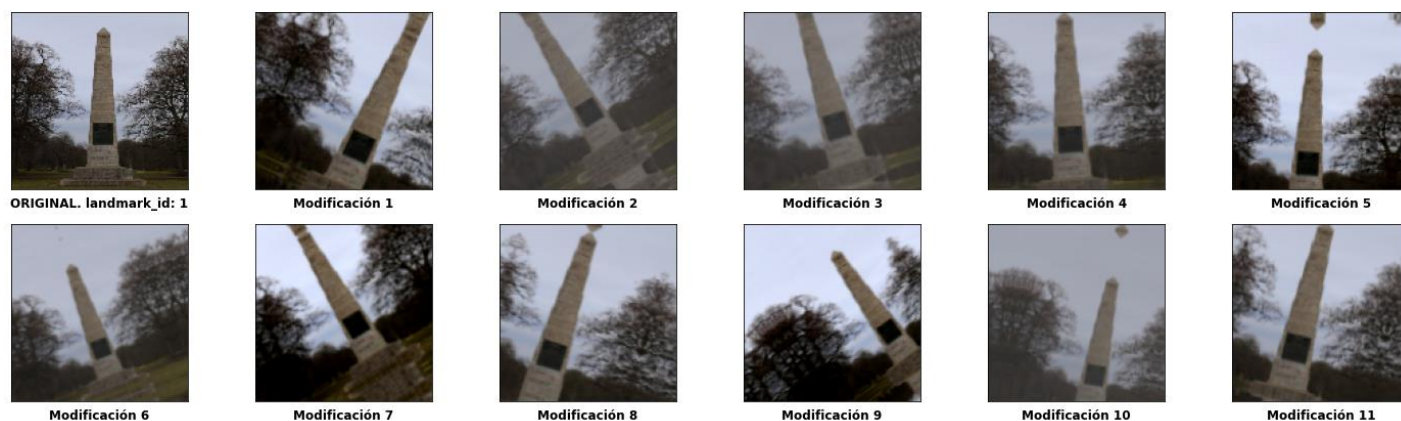
Figura 6-14. Ejemplo de aplicación de Data Augmentation
