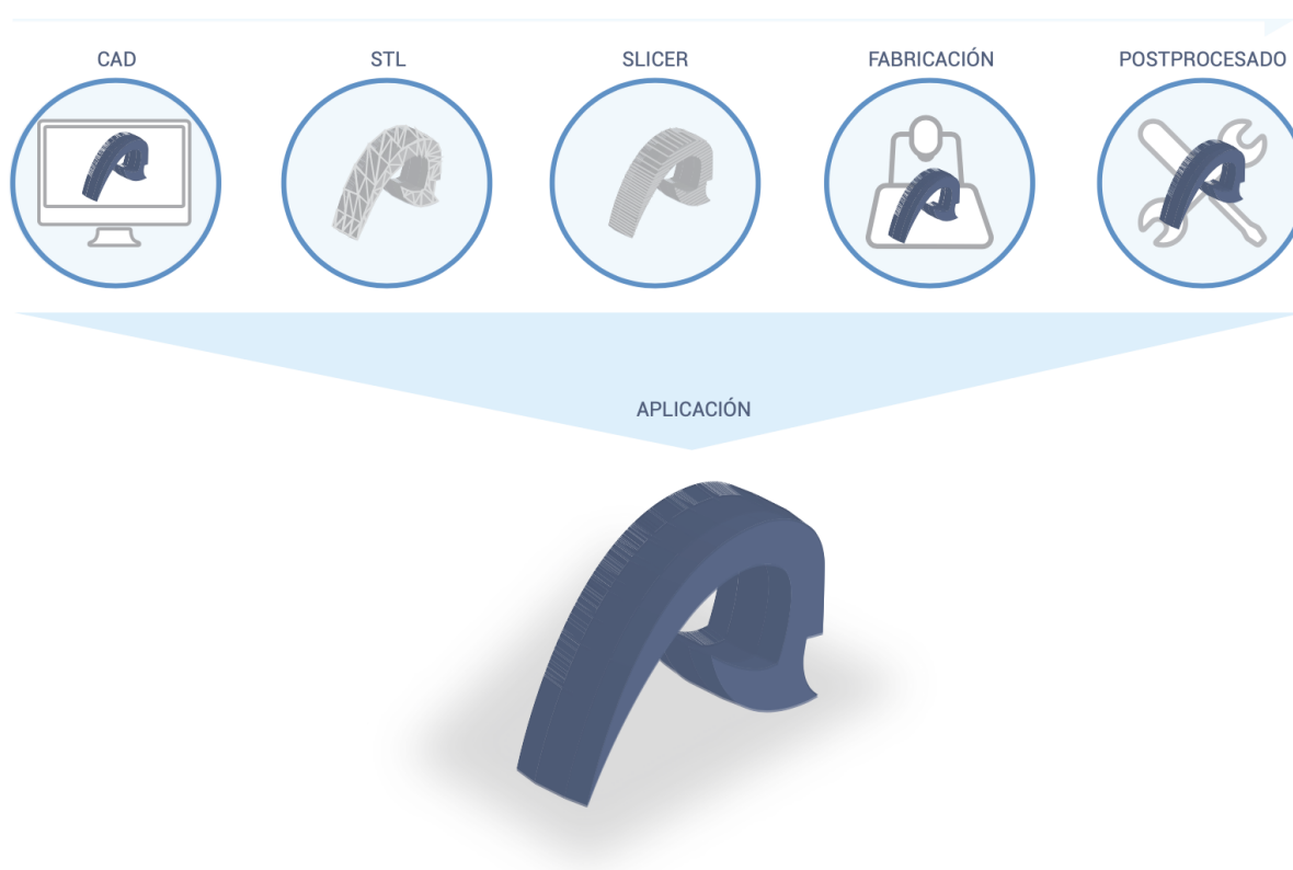
Ilustración 3. Procedimiento para la elaboración de una pieza mediante fabricación aditiva [8].
