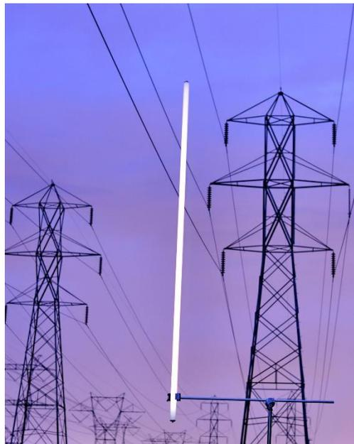
Figura 5. Ilustración del efecto capacitivo. [6]
