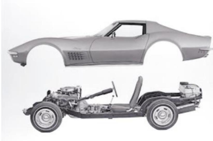
Figura 15. Diferenciación bastidor-chasis en automóvil. [8]
