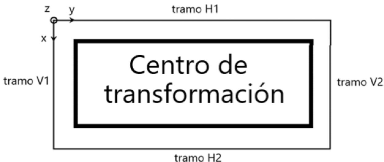
Figura 40. Planta del contorno con los tramos para calcular el campomagnético.
