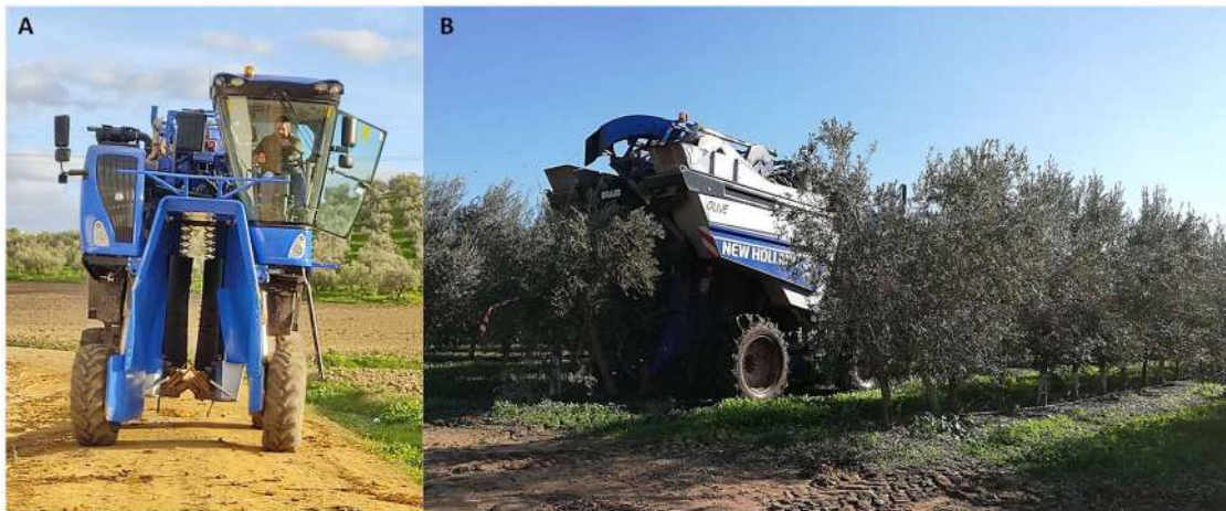
FIGURA 5 | Cosechadora de olivo modelo New Holland en vista frontal (A) y en funcionamiento (B) realizando la recolección mecanizada de aceituna a una hilera de olivos en super-intensivo en la finca experimental Buitrago (Ctra. Mairena del Alcor - Brenes, km 17) (Fotos realizadas por Pablo Díaz-Rueda y JM Colmenero-Flores).
