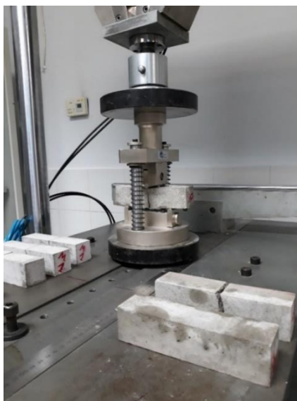
Fig. 5.15: Ensayo de resistencia a flexión
