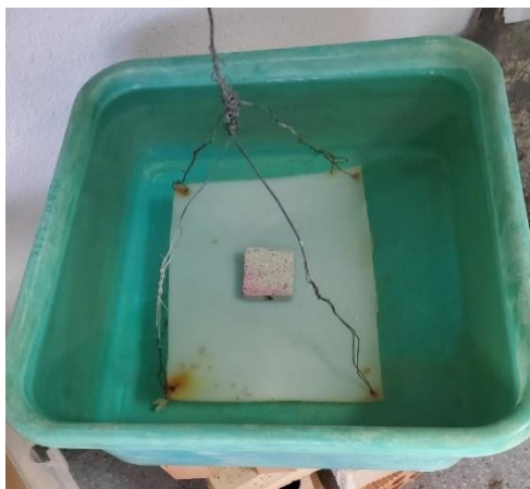
Fig. 5.12: Determinación de los pesos saturados sumergidos mediante balanza hidrostática
