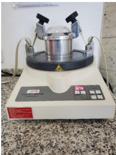
Fig. 5.17: Molienda fina en micro molino vibratorio.
