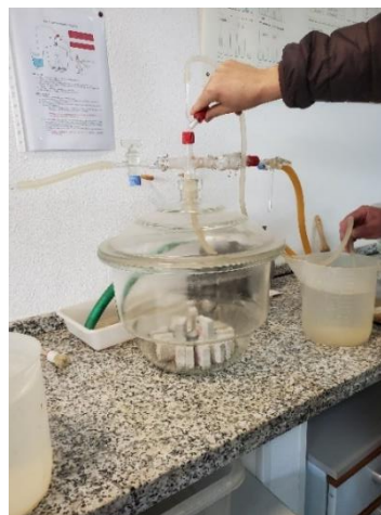
Fig. 5.11: Inmersión en agua de las probetas en recipiente al vacío
