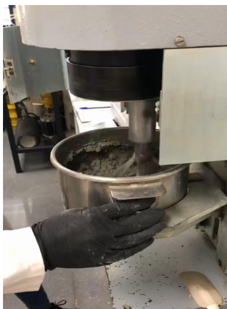
Fig. 5.3: Amasado de la mezcla antes de pasar a velocidad rápida
