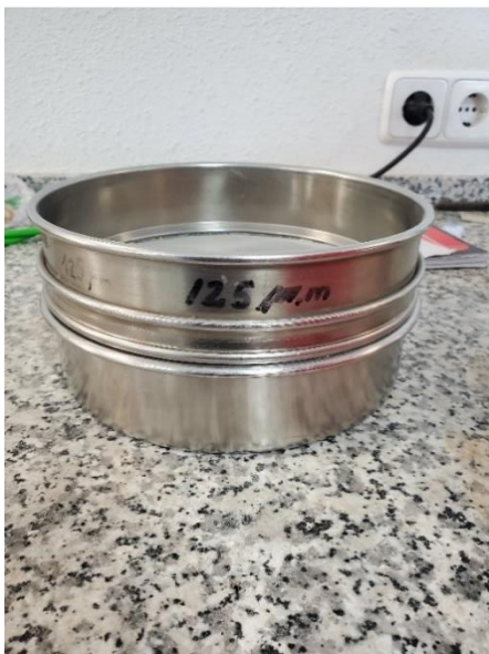
Fig. 5.19: Tamiz utilizado para preparar las muestras.
