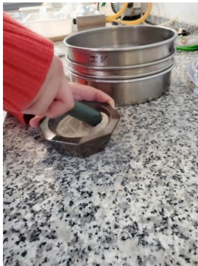
Fig. 5.18: Trituración de manera manual.
