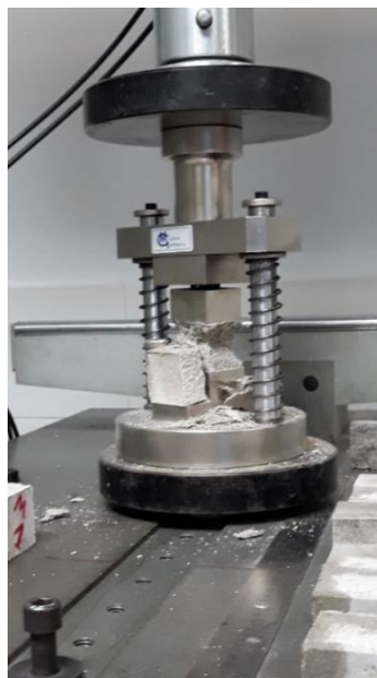
Fig. 5.16: Ensayo de resistencia a compresión
