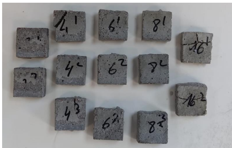
Fig. 5.13: Muestras recuperadas después de ser saturadas
