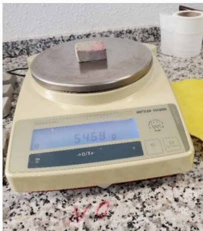
Fig. 5.10: Pesado de muestra de mortero
