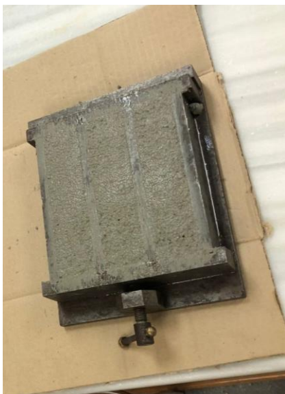
Fig. 5.5: Probetas en los moldes después de nivelar y suavizar la superficie
