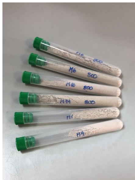
Fig. 5.20: Muestras preparadas para el análisis mineralógico.
