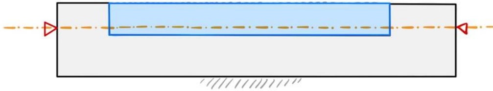
Ilustración 2-12 Vertido de hormigón con armadura pretesa
