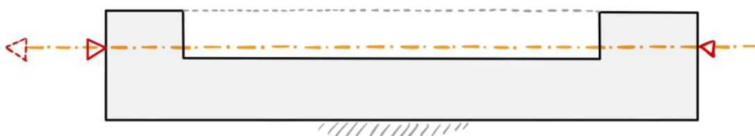
Ilustración 2-11 Tesado armadura pretesa
