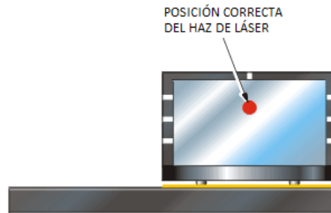
Figura AI. 121 Haz de láser sobre espejo giratorio
