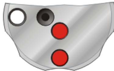
Figura AI. 39 Ajuste de intensidad en el obturador del cabezal láser
