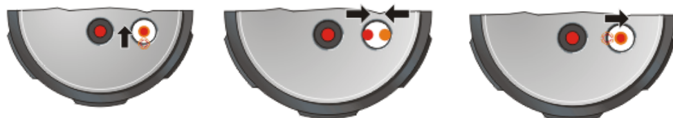
Figura AI. 11 Diferentes casos de desalineación en el objetivo del obturador
