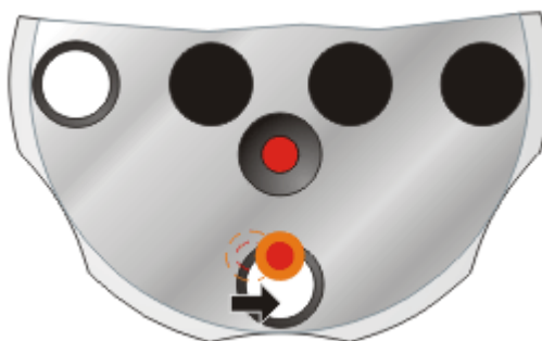
Figura AI. 53 Ajuste horizontal del cabezal láser
