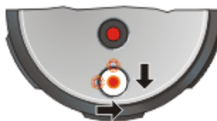
Figura AI. 19 Desalineación del objetivo del obturador
