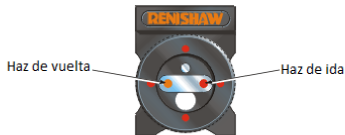
Figura AI. 13 Interferómetro de rectitud
