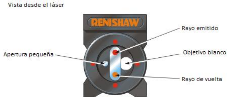
Figura AI. 89 Interferómetro de rectitud
