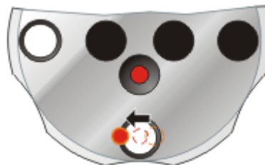
Figura AI. 37 Ajuste de ladeo en el obturador del cabezal láser
