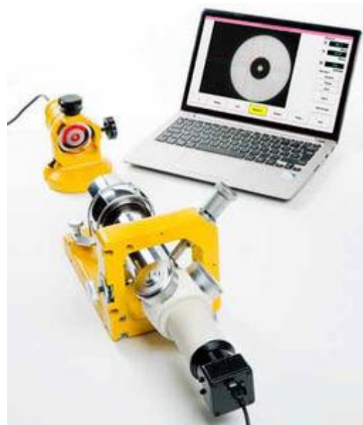
Figura 13 Telescopio electrónico de alineamiento
