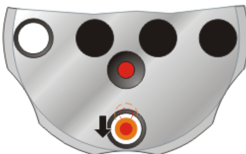
Figura AI. 54 Ajuste vertical del cabezal láser
