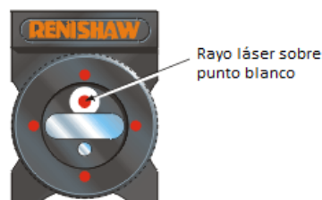
Figura AI. 88 Interferómetro de rectitud
