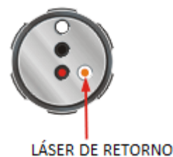
Figura AI. 105 Haz de láser sobre obturador del cabezal láser
