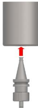
Figura AI. 127 Montaje copa magnética sobre husillo
