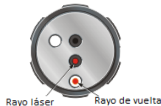
Figura AI. 91 Obturador del cabezal láser
