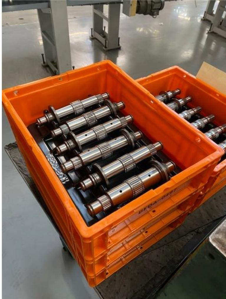
*Ilustración 12 Bacs de pieza acabada. Eje 2*
