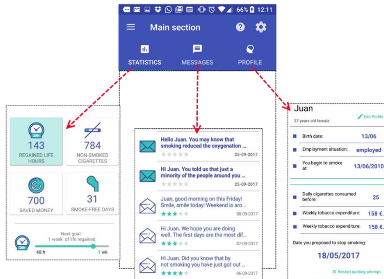
Figura 4: Secciones principales de la aplicación. La pantalla principal contiene un menú de pestañas para navegar entre las secciones principales. En el borde superior de la pantalla se sitúan tres botones, de izquierda a derecha, el acceso al menú lateral desplegable, el acceso al tutorial de la aplicación para esta pantalla y el acceso a la configuración de la aplicación.
