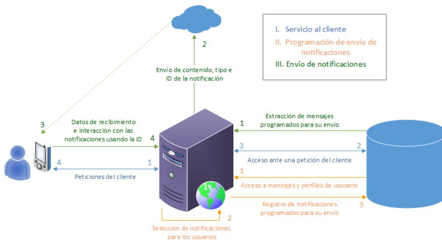
Figura 2: Diagrama de red del sistema desarrollado. En él se recogen las funciones que contempla el servidor.
