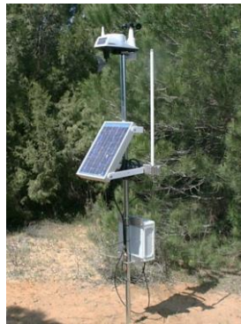
Figura 5: Nodo sensor de la red ICARO
