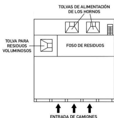
Ilustración 2. Esquema de la zona de descarga de residuos (16).
