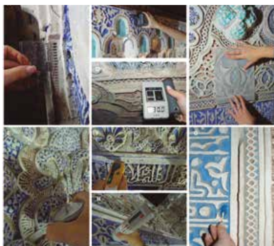
Figura 12. Métodos para la inspección de las yeserías: (A) medición de longitud, abertura y profundidad de fisuras y grietas, (B) lectura mediante GPR, (C) calcos de la geometría, (D) detección de elementos metálicos y (E) Dureza superficial C-Shore, (F) Medición de la humedad de conductividad, (G) comprobación de estabilidad de la policromía y (H) y medición del Color Cie Lab.
