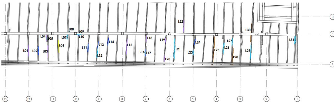
Imagen 18: Levantamiento de lesiones. Fuente: Proyecto de intervención patrimonial iglesia Detif.
