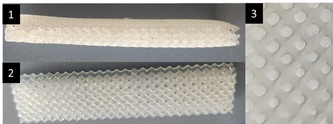
Figura 31: Probetas impresas de 2mm de lado
