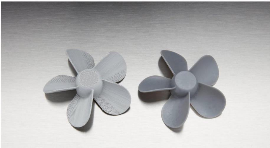
Figura 6: Comparativa de acabados superficiales entre FDM y SLA
