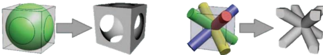
Figura 8: Ejemplos de diseño de celdas unitarias
