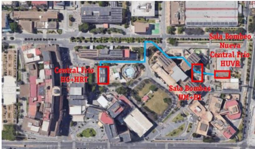
Ilustración 12 - Trazado de tuberías del anillo de frío
