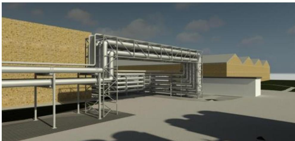
Ilustración 11 - Paso de tuberías por racks
