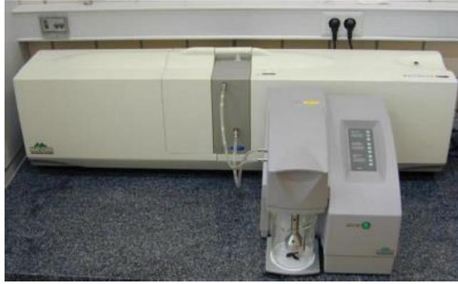
**Figura 3.9.** Equipo Mastersizer 2000 utilizado para determinar la distribución granulométrica de las muestras de polvo.
