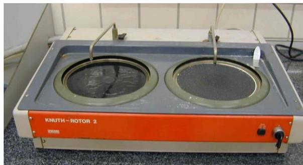
Figura 3.33. Lijadora orbital Struers Knuth-Rotor-2.
