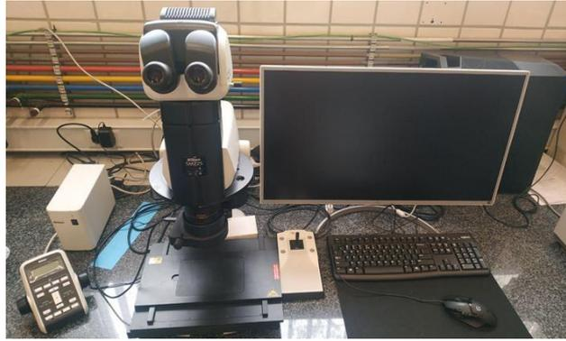
Figura 3.35. Lupa estereoscópica Nikon SMZ 25.
