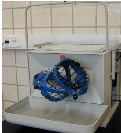
Figura 3.4. Molino mezclador.
