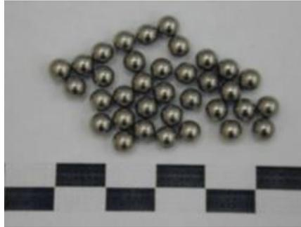
**Figura 3.2.** Bolas de acero al cromo-níquel empleadas en la molienda.
