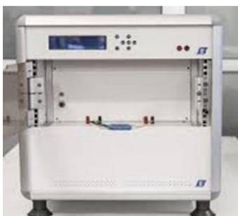
**Figura 3.39.** Equipo AMH-1KS para las medidas magnéticas de los compactos.
