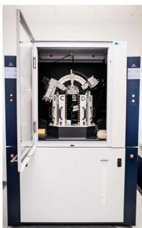
Figura 3.13. Difractómetro Bruker D8 Advance A25.
