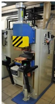
**Figura 3.19.** Equipo de soldadura por resistencia eléctrica (Beta-214 MF) adaptado como equipo de SRE-MF.
