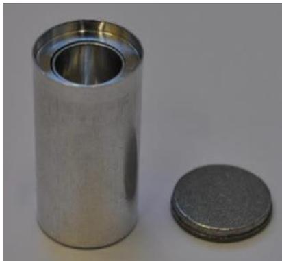
**Figura 3.8.** Vasito portamuestras para medida de la densidad de polvos del picnómetro automático Accupyc II 1340.
