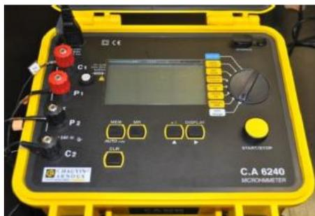
Figura 3.29. Micro-ohmiómetro modelo CA-6240, Chauvin Arnoux.
