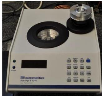
Figura 3.6. Picnómetro automático Accupyc II 1340.
