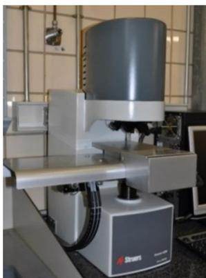
**Figura 3.38.** Microdurómetro Struers Duramin A300.
