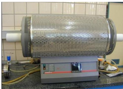
Figura 3.18. Horno de tubo horizontal de alto vacío Carbolite HVT 15/50/450.
