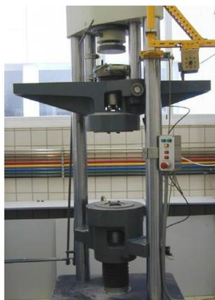
Figura 3.17. Máquina universal de ensayos Suzpecar MUE-60.
