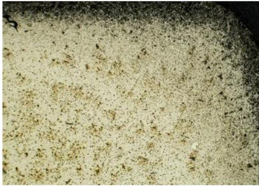
**Figura 5.30.** Imagen del compacto FeSiB 4-700 oxidado a los pocos minutos de su preparación metalográfica.
