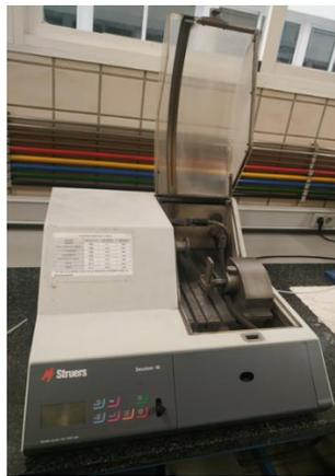
**Figura 3.31.** Cortadora Struers modelo Secotom-10.
