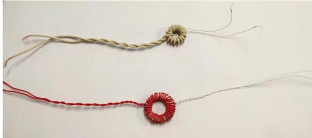
Figura 3.41. Muestra preparada con los devanados primario y secundario para su medición.
