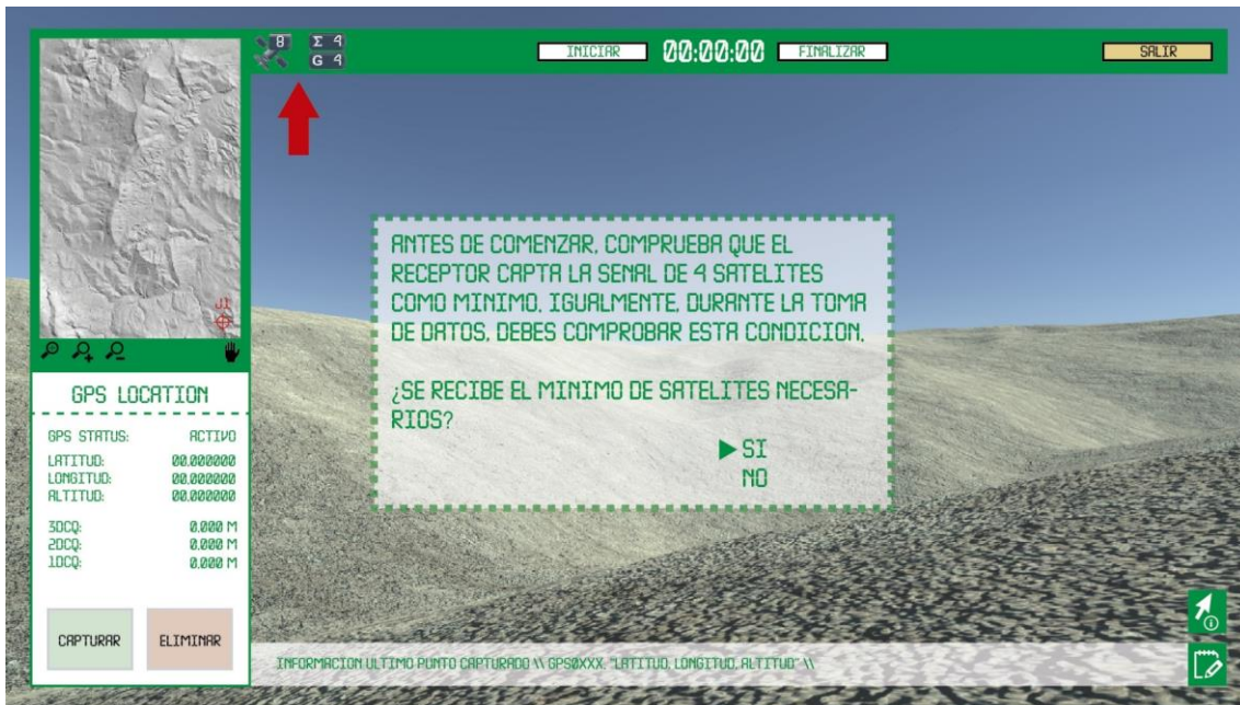
Pantalla 23. El juego notifica al jugador de que antes de iniciar el trabajo, ha de comprobar que el receptor GPS capta la señal como mínimo 4 satélites. Esto es importante para tomar unas mediciones precisas. El simulador estará programado para que en algunos momentos el número de satélites captados que se muestre baje de 4. En estos casos, el jugador deberá ubicar un punto distinto cercano.
