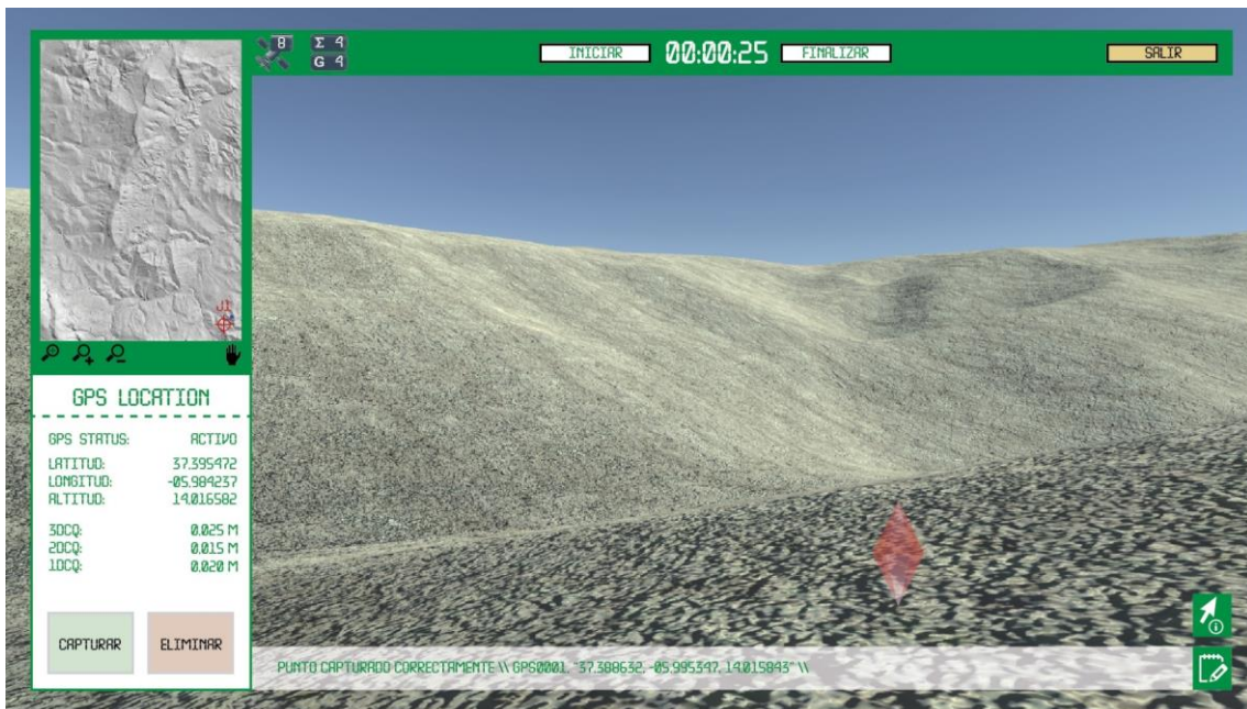
Pantalla 30. Cuando el punto ha sido finalmente capturado, aparece un mensaje de confirmación en la banda inferior. Además, la ubicación del punto queda marcada visualmente en el terreno mediante un octaedro de color rojo. Igualmente, en la vista de mini mapa, aparece un punto de color azul en el lugar donde se haya colocado el punto.
