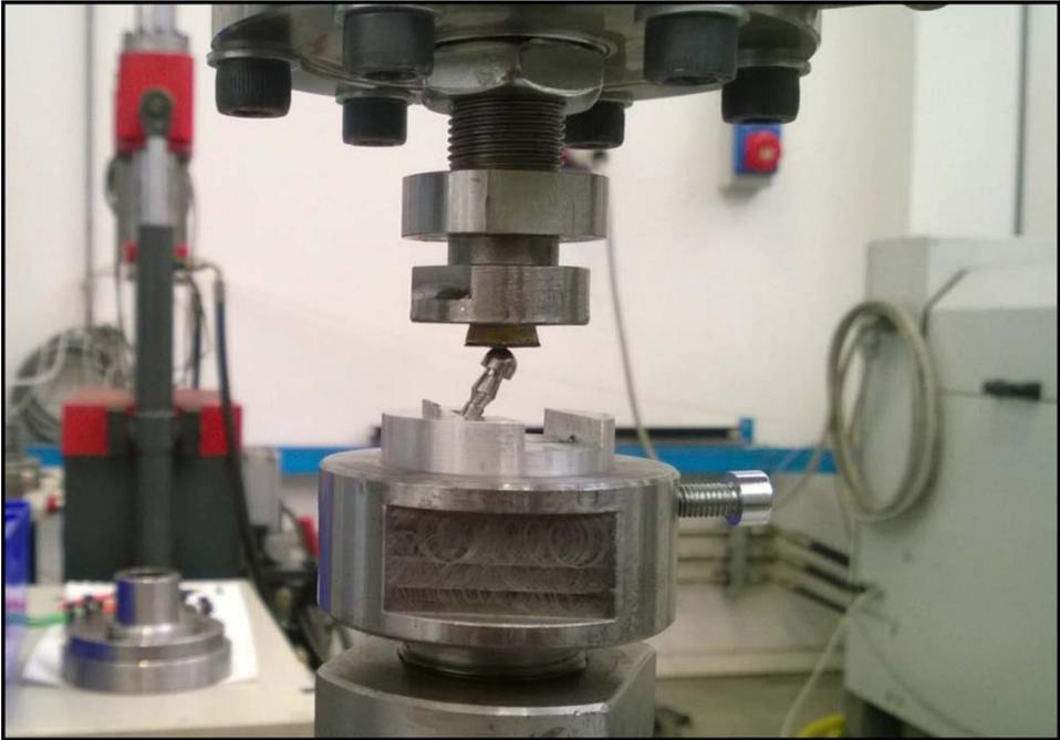
*Imagen 5. Fotografía realizada en el establecimiento en el que se desarrolló, la configuración de prueba utilizada durante la caracterización estática.*
