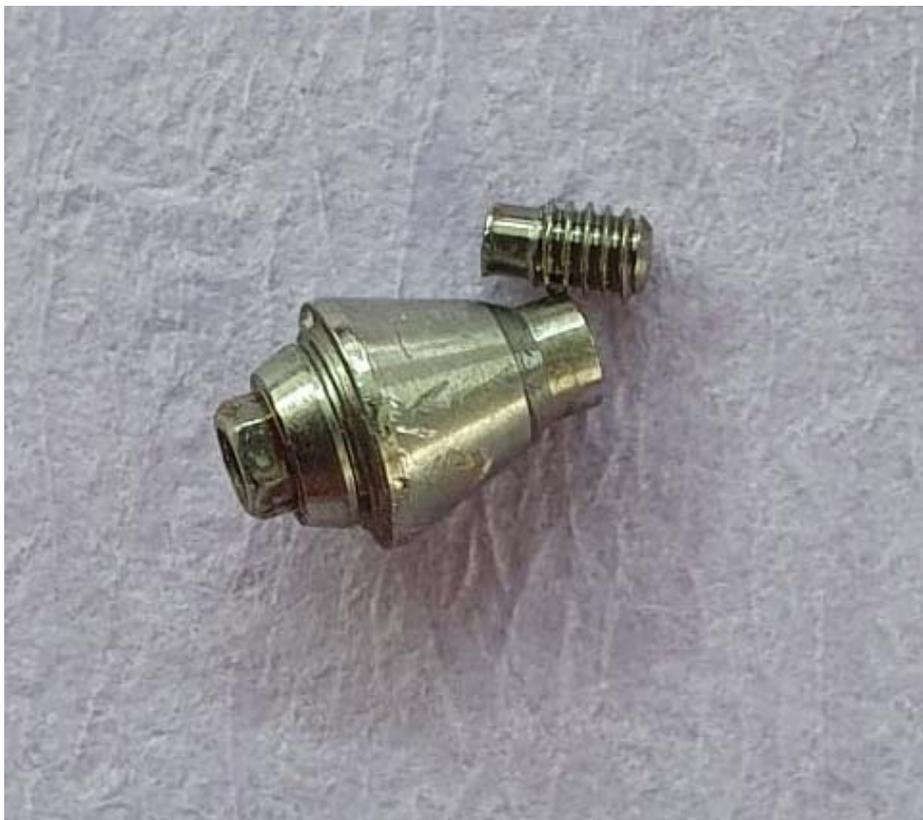
*Imagen 3: Fractura del pilar intermedio (Multi Unit) de una prótesis fija implantosoportada, producto de un exceso de carga oclusal sobre la rehabilitación.*
