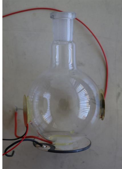
Figura 8: Transductores de ultrasonidos acoplados a una matraz esférico
