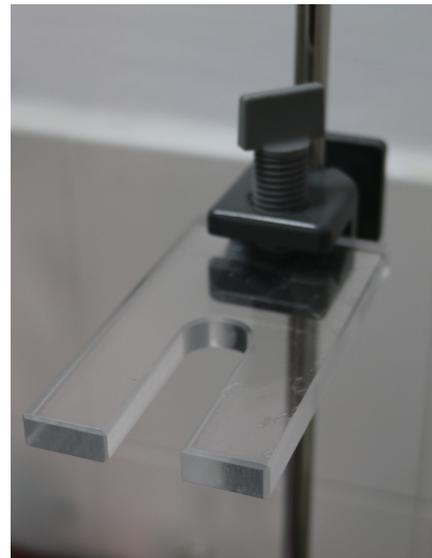
Figura 17: Soporte de metacrilato usado para colgar el matraz
