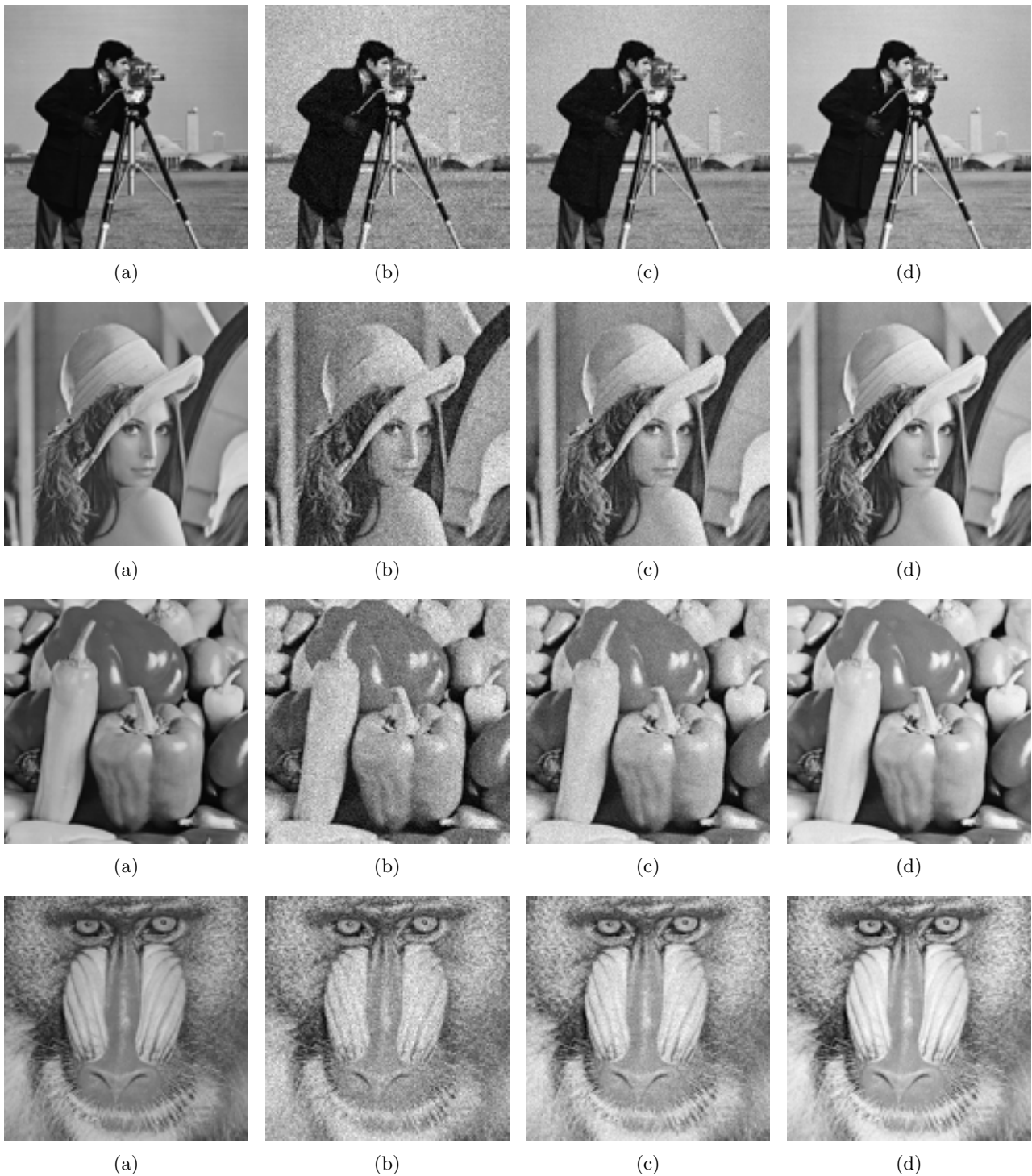
FIGURA 2.5: (a) Imagen en escala de grises. (b,c,d) Imágenes de 8 bits reconstruidas mediante Quanta Imaging con 2^m - 1 planos binarios : b) n = 8 , c) n = 10 y d) n = 14 . Ventanas temporales de exposición, \tau , en todos los casos de 1\mu\text{s} .
