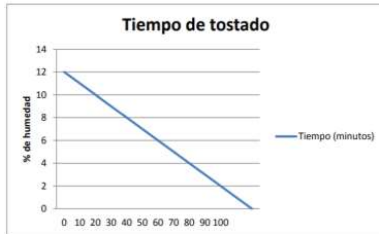
Figura 4.2. Variación de humedad en el cacao tostado a 150°C
