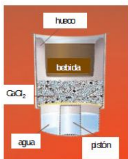
Figura 18. Esquema del interior de un envase autocalentable. Fuente: recuperada de Pinto et al. (2009).
