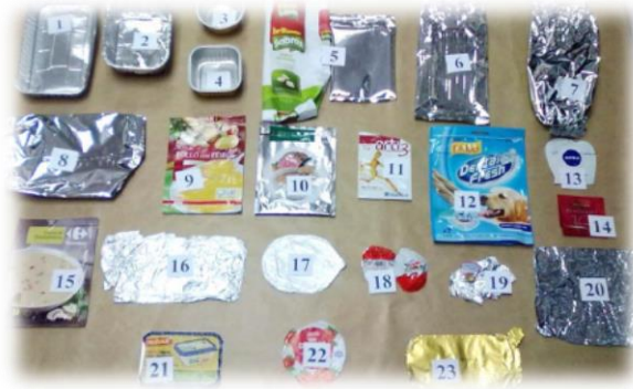
Figura 3. Diferentes tipos de envases de aluminio: 1-4 semirrígidos; 5-15 flexibles (poco contenido en aluminio); 16-23 flexibles (mucho contenido en aluminio). Fuente: recuperada de López et al. (2013).
