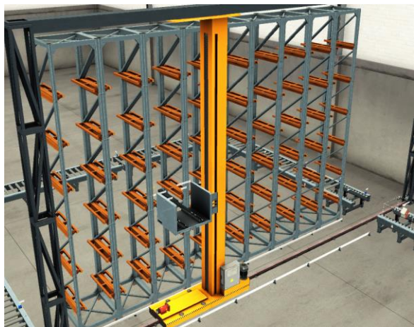
Figura 3-26: Apiladora de productos FACTORY IO
