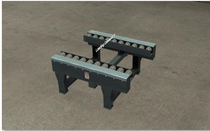
Figura 3-4: Cintas de carga o descarga FACTORY IO
