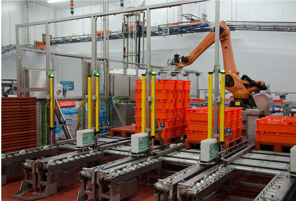
Figura 10. Robot biarticulado encargado de paletizar el producto (Procavi, 2022).
