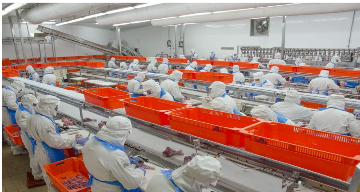
Figura 7. Sistema de monotarea en una de las salas de despiece.
