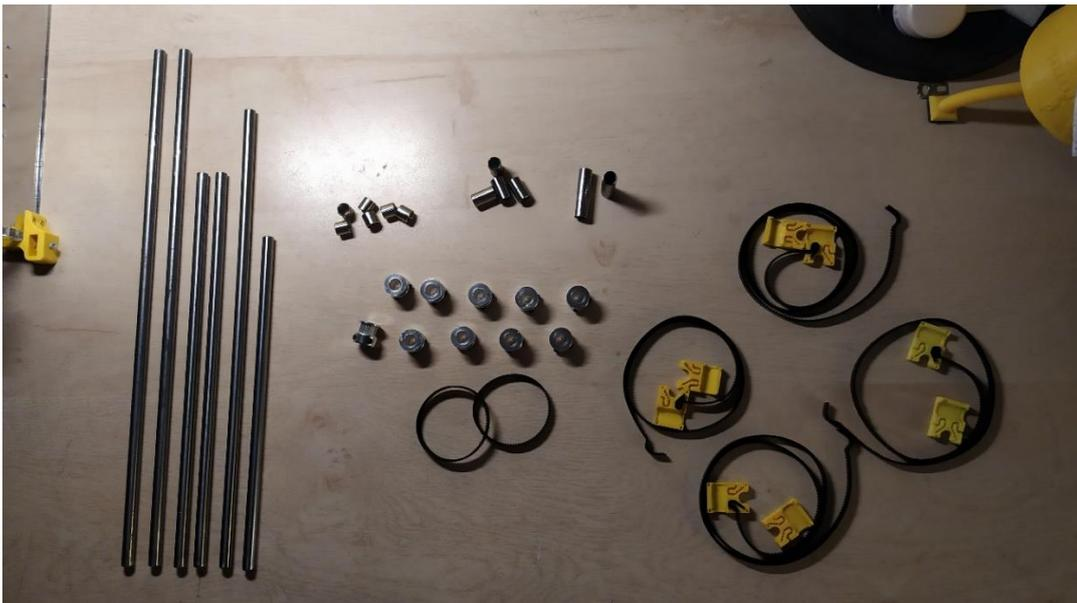
Figura 3.14. Componentes mecanismo transmisor
