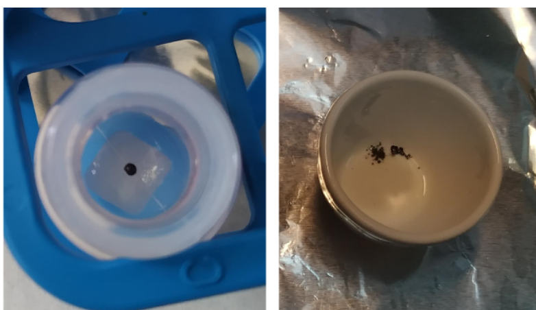
Figura 6.10: A la izquierda tubo de teflón que contiene el Fe seco portador de la fracción de Pu. A la derecha, la muestra resultante junto con el polvo de Nb, preparados para la mezcla.
