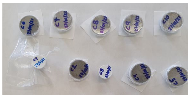
Figura 6.1: Muestras preparadas para espectrometría gamma.
