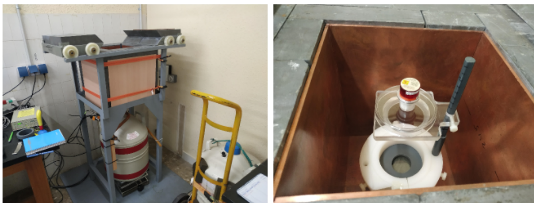
Figura 5.9: A la izquierda vemos el montaje del detector HPGe (XtRa) utilizado y a la derecha el montaje para la medida del coeficiente de autoabsorción, con una muestra y fuentes puntuales encima.
