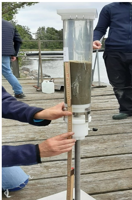
Figura 3.2: Recogida de sedimentos mediante el uso de un corer .
