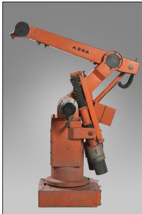
Figura 4. Robot IRB6, primer robot europea de accionamiento eléctrico.
