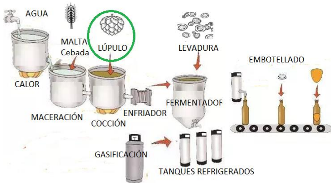
Figura 21. Esquema simplificado de la fabricación de la cerveza. Elaboración propia.
