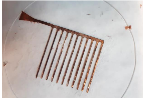
Figura 7. Circuito del peine transferido sobre un sustrato de cuarzo.
