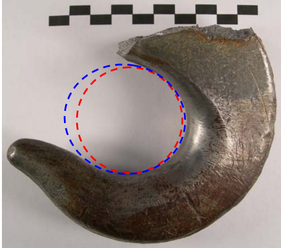
Figura 1. Imagen de la parte del gancho fracturada. Se incluye una escala graduada en cm.
